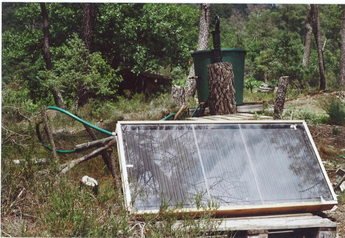
*À sa première utilisation, en juillet 2007, le capteur a tellement bien fonctionné que l'eau a bouilli : les plaques isolantes ont fondu ainsi que tous les raccords en plastique et les bouchons obturant les sorties non utilisées du radiateur. En réparant les fuites, les vitres ont été cassées. Il a depuis été réparé en protégeant l'isolation et les raccords. Il est en fonctionnement depuis mai 2008.*
