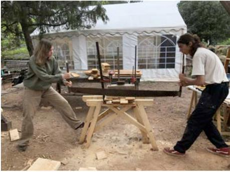
Le procédé qui a été le plus utilisé consistait à scier les bardeaux un par un à la scie égoïne avec une coupe à 90°, puis dans un deuxième temps à réaliser le biseau au ciseau à bois (+ maillet) ou l'ébauchoir (+ massette) avant de rogner l'extrémité du biseau.
